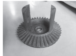
圖17 差速器外殼及從動齒輪
