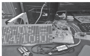
圖 18：電子科單晶片結合 LED 時鐘成品
