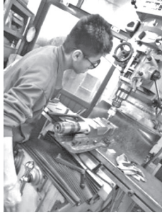
圖 (a)：使用銑床尋邊鑽孔製作零件
