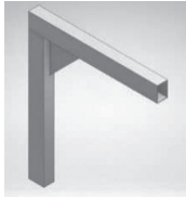
圖 13：三角形補強板
