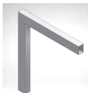
圖 7：梁柱無補強板 3D
