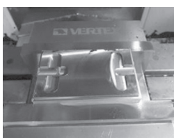
圖 7c 鍍鈦刀銑削工件
