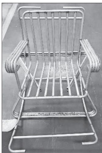
圖13 / 體重壓迫大弧底部遭受變形
