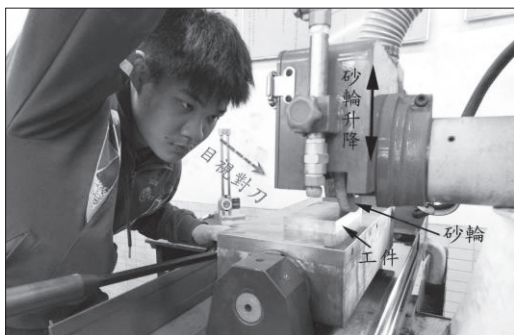
圖1／磨床操作；目視對刀
