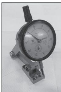
圖13 / 砂輪對刀機構作品
