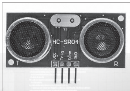
圖 6 / 超音波感測器SR04
