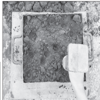
圖19 使用尖砂 槌將砂模 搗緊
