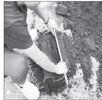
圖20 使用刮板 將下砂模 刮平
