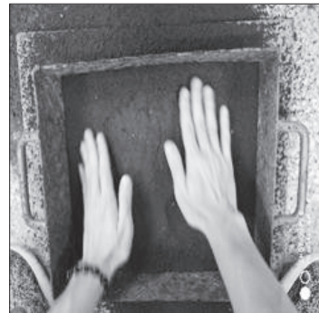
圖18 篩上面砂 並且壓緊
