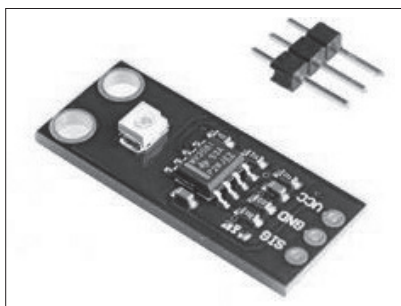
圖 7 / GUVA-S12SD太陽紫外線強度感測器
